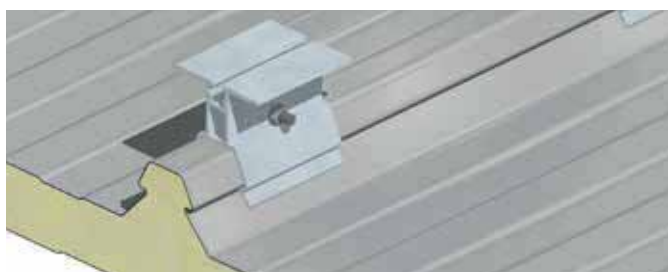
Dettaglio aggancio di accessori a copertura
