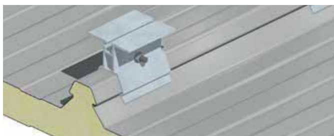
Detaliu agatarii cu accesorii de acoperis
