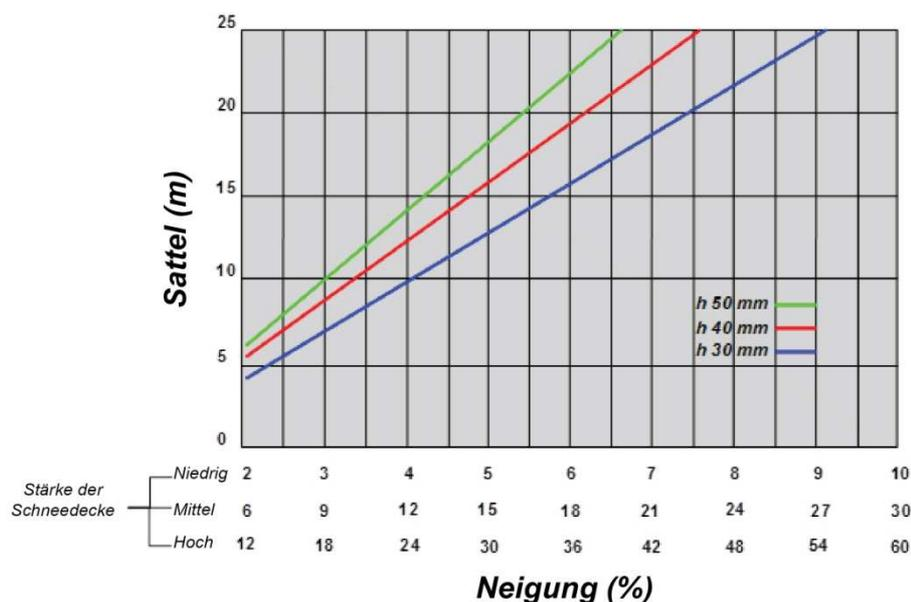
Im ersten Fall kann die Mindestneigung im Hinblick auf die Klimazone und Falzhöhe dem **Diagramm der Neigungen** entnommen werden; es empfiehlt sich (bei einer reduzierten oder mittleren Schneedecke) eine Neigung von mindestens 7 %.
