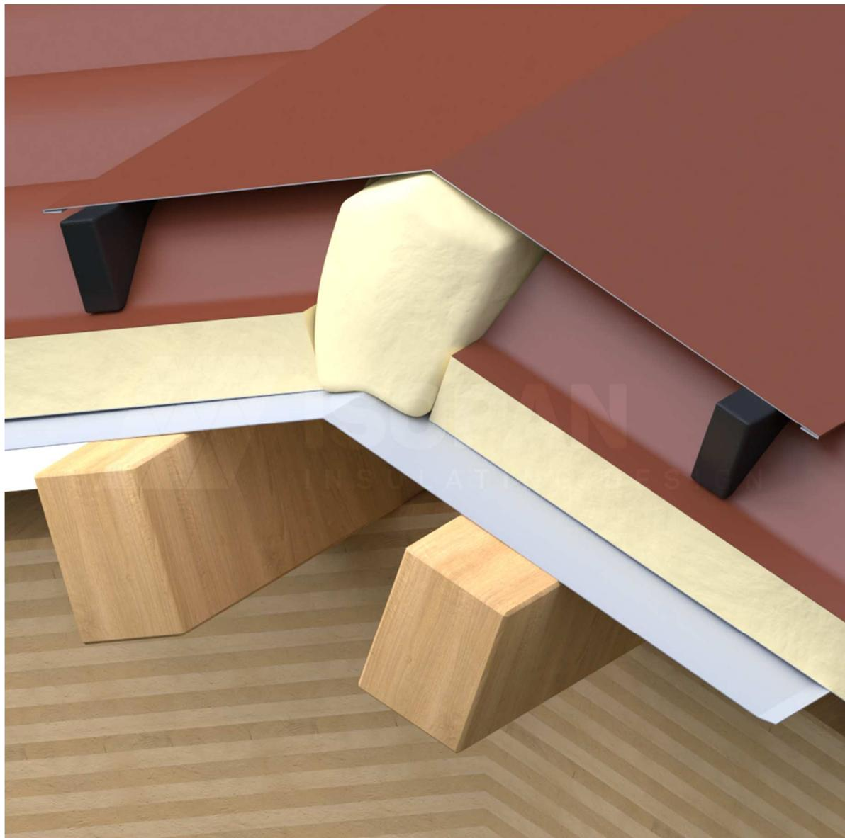
Dachfirst Typ 5: Vertikalschnitt
