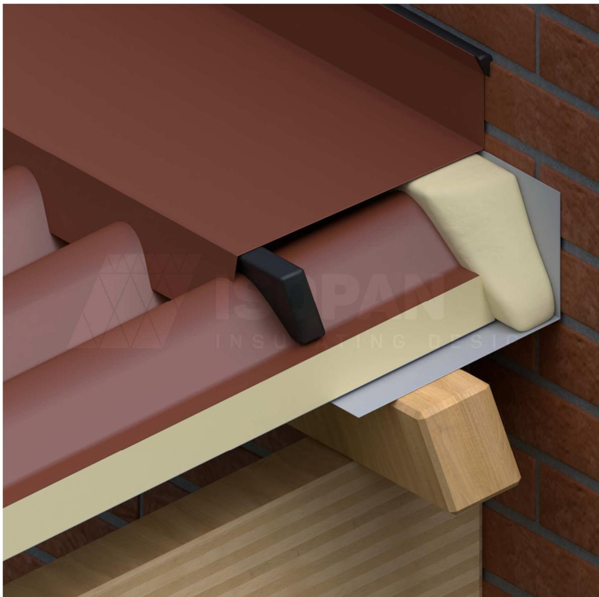
Verbindung der Abdeckung bei traditioneller Struktur im Bereich des Dachfirsts
