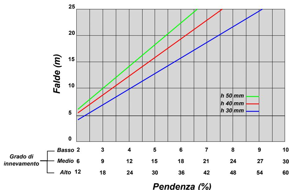
Nel primo caso la pendenza minima, in relazione alla zona climatica e all'altezza della greca, si può rilevare dal **Diagramma pendenza**; si consiglia (in caso di grado d'innevamento ridotto o medio) una pendenza non inferiore al 7%.
