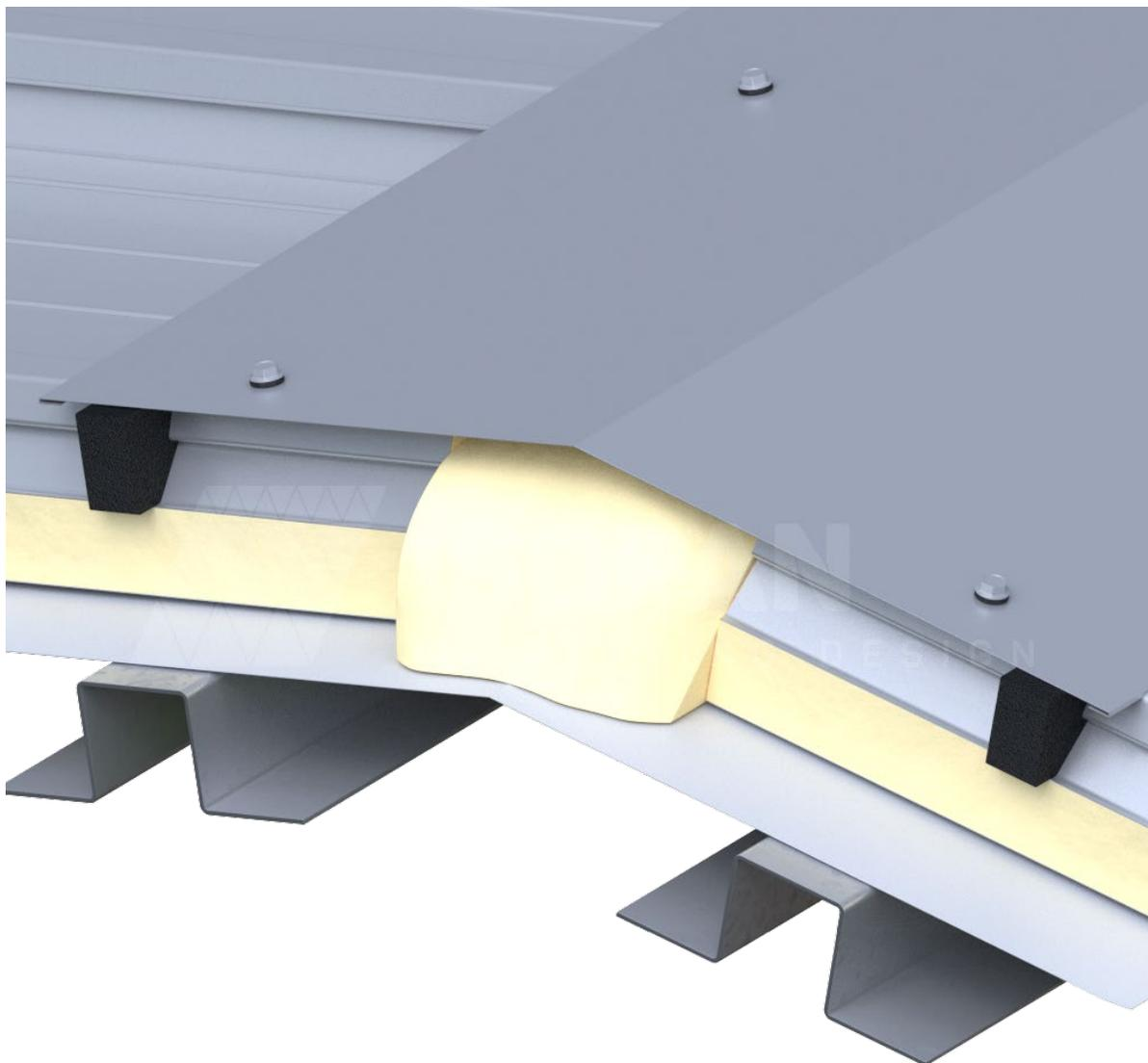
Colmo di copertura tipo 1: sezione verticale
