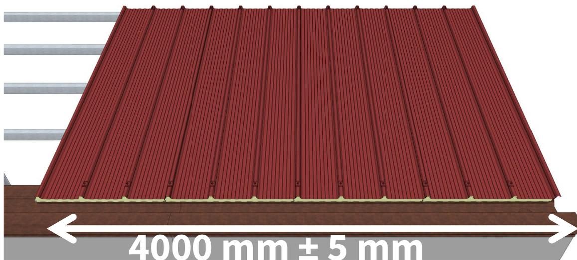
**Nota:** occorre prestare attenzione al corretto accostamento dei pannelli in fase di montaggio (4 pannelli = 4000 mm ± 5 mm) in modo da evitare problemi durante la successiva fase di installazione del colmo, come indicato in figura.
